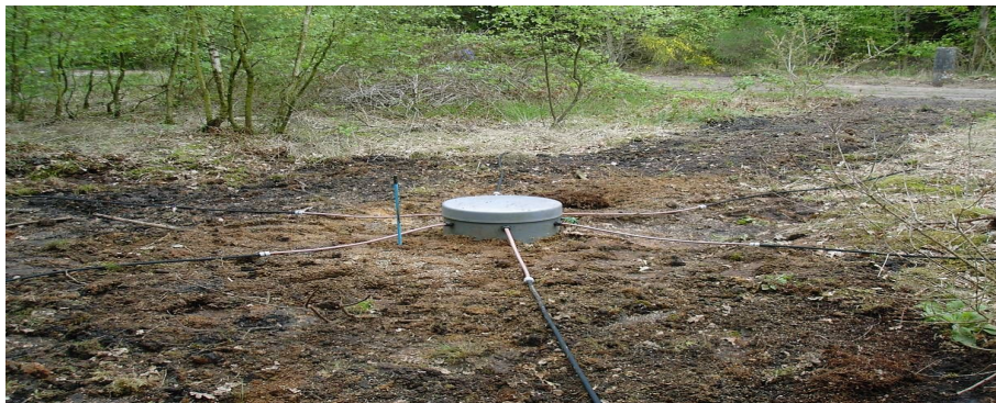
FIG. 1.3.1.1.3 – GEOFONE USADO NO LOFAR
