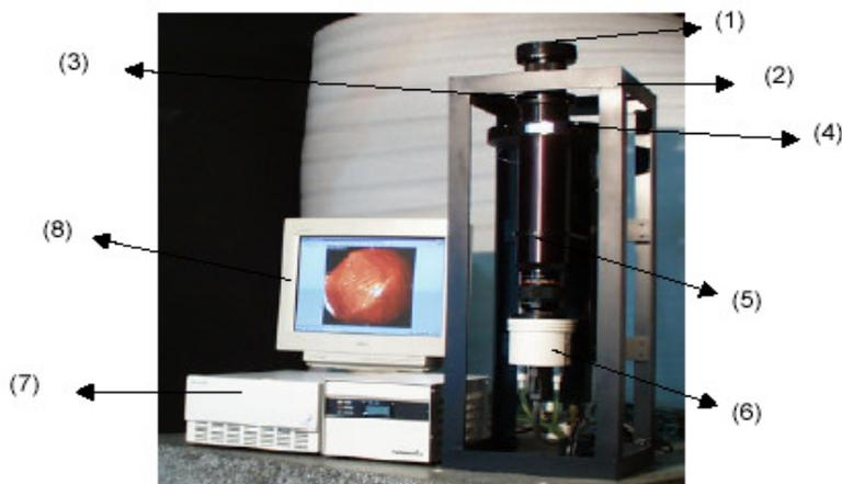
Figura 2 -Imageador CCD all-sky sendo: (1) lente do tipo all-sky ; (2) rack; (3) sistema telescópico de lentes; (4) roda de filtros de interferência ótica; (5) sistema de reconstrução da imagem; (6) câmera CCD; (7) sistema de refrigeração da câmera CCD e (8) microcomputador.
