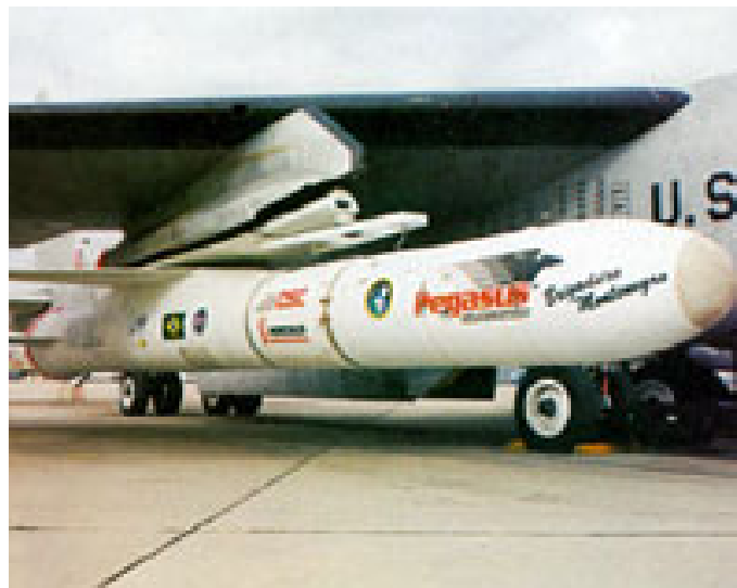
Fig. 6. B-52 da NASA preparado para o lançamento do SCD-1
