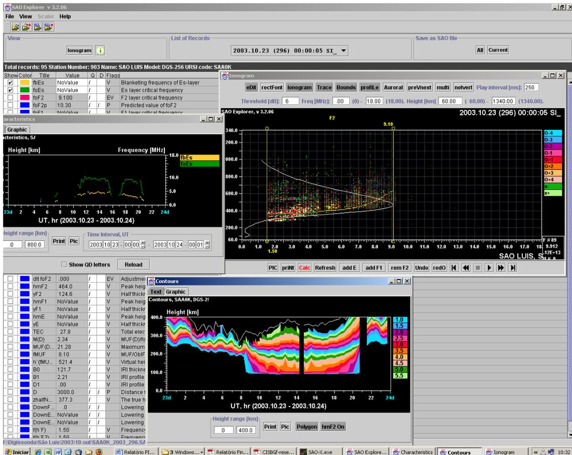
Figura 1.6- Ilustração do programa SAO-Explorer onde são visualizadas as diversas telas para manipulação e visualização dos ionogramas e parâmetros ionosféricos.
