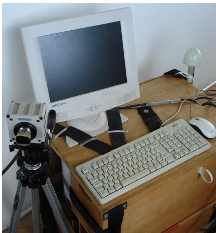
Figura 2.7 – Câmera rápida FASTCAM 512 PCI 2k em seu módulo móvel utilizado na campanha brasileira.
