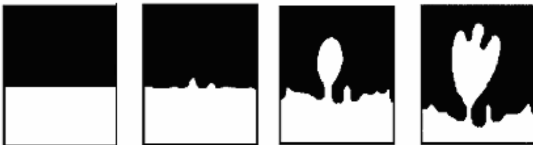
FIGURA 4.3 – Ilustração da Teoria da instabilidade hidrodinâmica RT, FONTE: Kelley (1989, pag. 76 e 122) retirada da dissertação Rodrigues, 2003.
