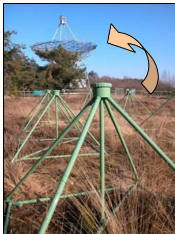
Fig. 3.4. Milhares de antenas dipolo simularão uma antena de prato com 350 Km de diâmetro.
