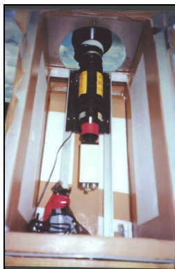
Figura 3.2 – Câmara de TV do Image Observation System , instalado no prédio 5 do Observatório Espacial do Sul – OES/CRS/INPE - MCT
