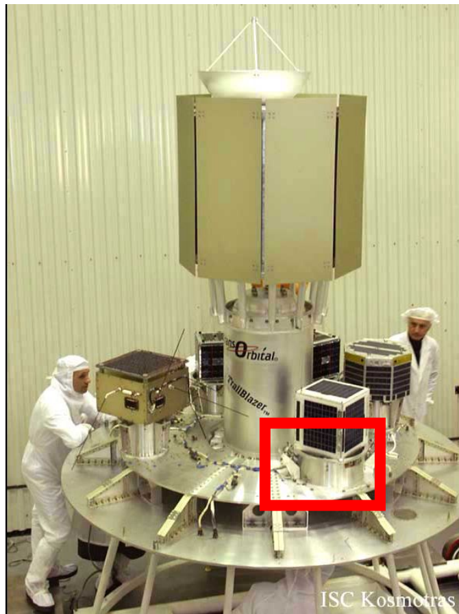
Figura 28: Estrutura de lançamento do Dnper. Destacado o anel de união.
