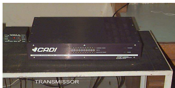
Figura 4.4: Sondador digital CADI (Canadian Advanced Digital Ionosonde)
