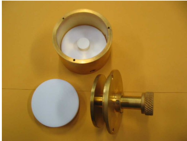
Figura 3.12.4 – Fotografia ilustrativa do procedimento experimental de determinação do fator de qualidade
