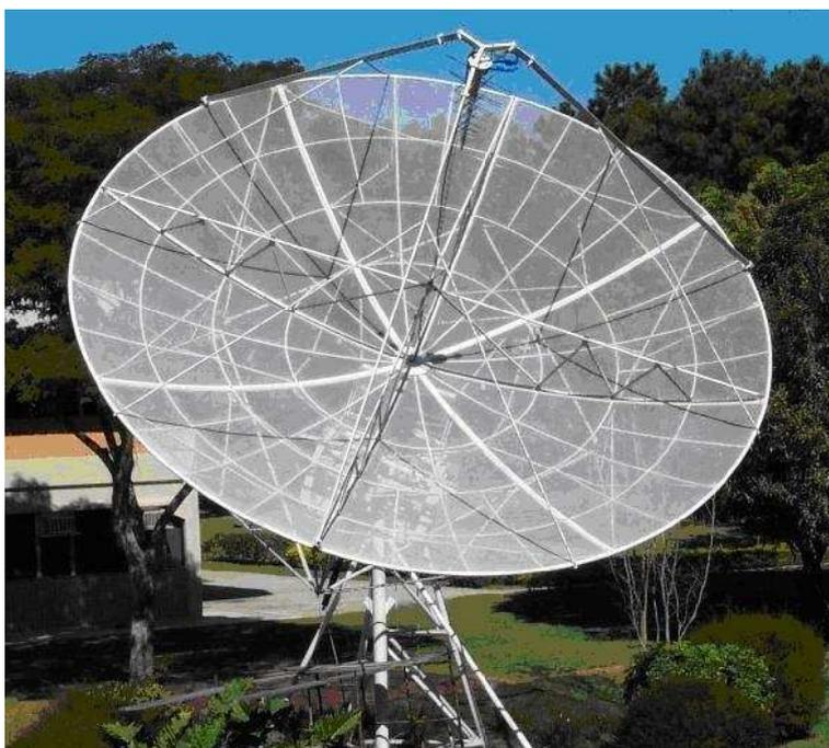
Figura 4: Visão da antena de 9m de diâmetro do BSS.
