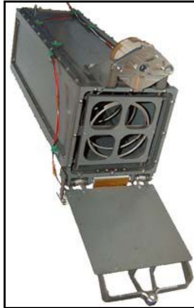
Figura 11: Abertura do P-POD para ejeção dos Cubesats
