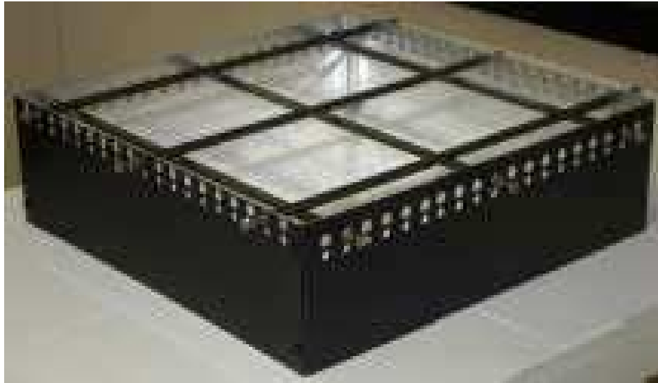
Figura 2 – Exemplo de caixa de simulação de cargas térmicas.
