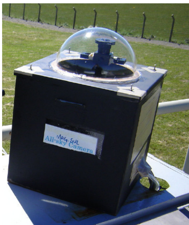
FIGURA 11: Imagem da Câmera Imageadora Fish-Eye, instalada no OES. FONTE: Imagem pertencente aos arquivos do LMLA.
