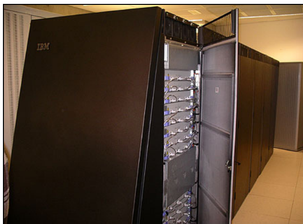
Fig. 3.6. Computador Central Bluegene, utilizado na Estação Central de LOFAR.
