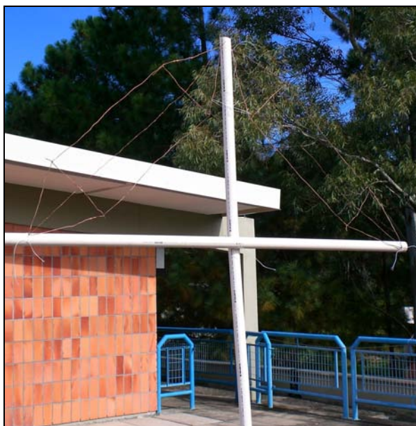
Fig. 4.22. Resultado final da antena dipolo NRL de LOFAR.
