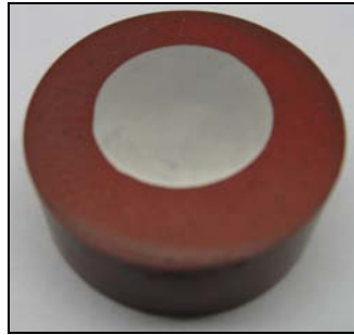
Fig. 4.5. Amostra envolvida com baquelite.
