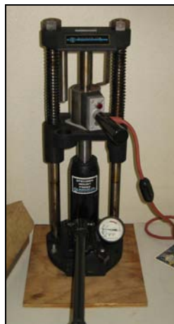
Fig. 4.4. Prensa hidráulica utilizada no processo de revestimento da amostra.
