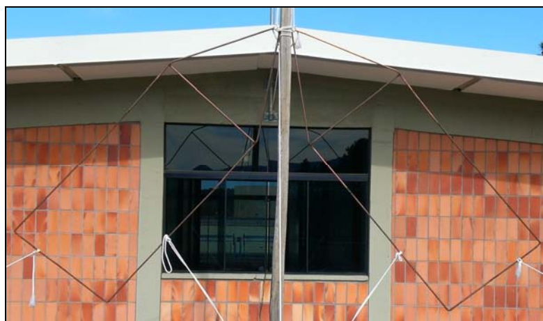
Fig. 4.18. Resultado final da concepção da antena dipolo de LOFAR.
