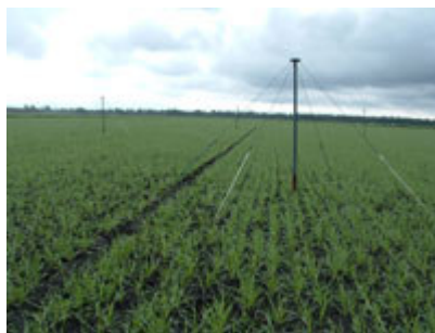
Fig. 2.2 – Antena de banda baixa – (30 – 80) MHz.
