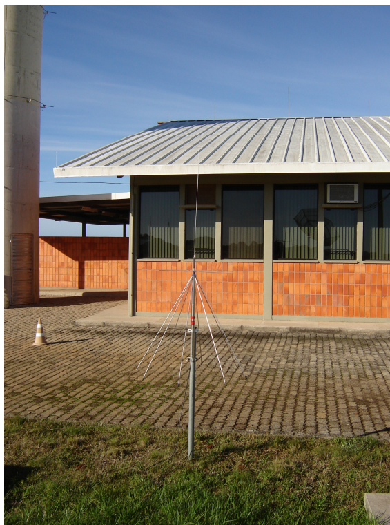
Fig. 5.2 - Antena Monopolo utilizada no Projeto e instalada ao lado do Prédio 2 no Observatório Espacial do Sul em São Martinho da Serra, RS.
