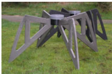
Fig. 2.3 – Antena de banda alta – (120 - 240) MHz.
