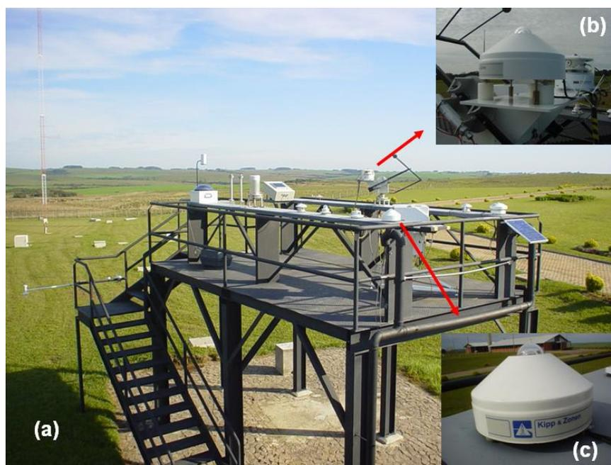
**Figura 4.1:** (a) Vista geral da Estação SONDA do Observatório Espacial do Sul do Centro Regional Sul de Pesquisas Espaciais – OES/CRSPE/INPE – MCT em São Martinho da Serra, RS; (b) Vista do *Piranômetro CM22*; (c) Vista do *Piranômetro CM21*.
