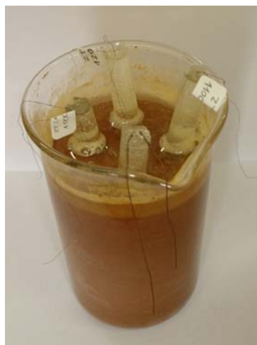
FIGURA 4: Sensores revestidos com resina, soterrados no solo de análise.
