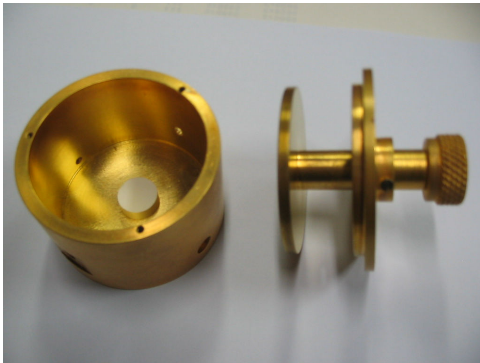
FIGURA 5 – Fotografia ilustrativa do procedimento experimental de determinação da constante dielétrica
