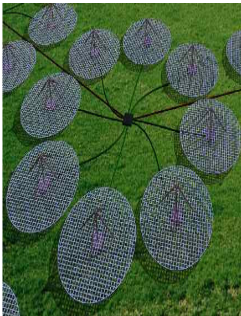
Figura 2.11.a – Distribuição das antenas numa das Estações LOFAR.
