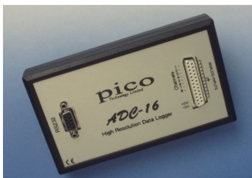
Figura 4.26 – Conversor A/D implementado no magnetômetro
