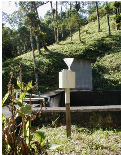
FIGURA 4.3. Foto do coletor tipo “bulk” instalado junto ao vertedor da bacia em Cunha.
