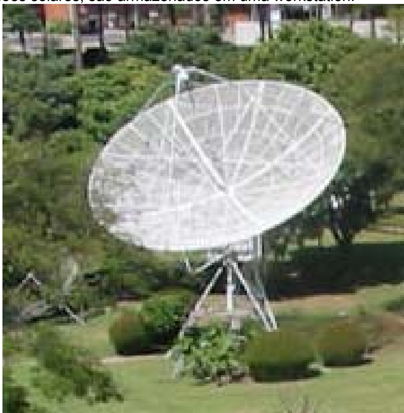
Fig. 1 – Visão da antena de 9 metros de diâmetro do BSS.
