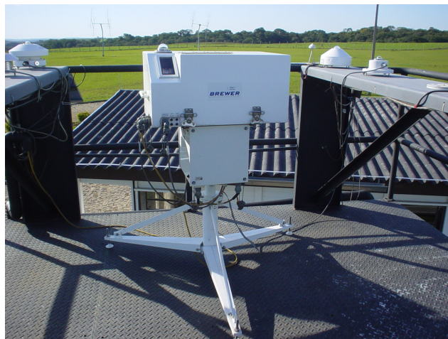
Fig. 4.5 – Espectrofotômetro Brewer modelo MKIII, instalado no Observatório Espacial do Sul.
