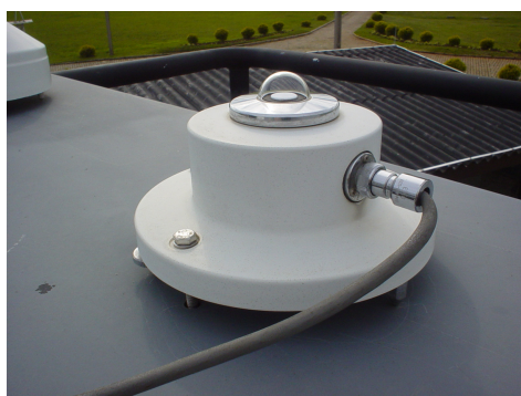
Fig. 4.12– Radiômetro UV-B MS-210 W instalado no OES/CRSPE/INPE – MCT, obtido a partir da cooperação Brasil – Japão.
