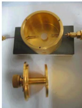
FIGURA 9 - Vista da caixa de teste blindada para determinar a frequência de ressonância.
