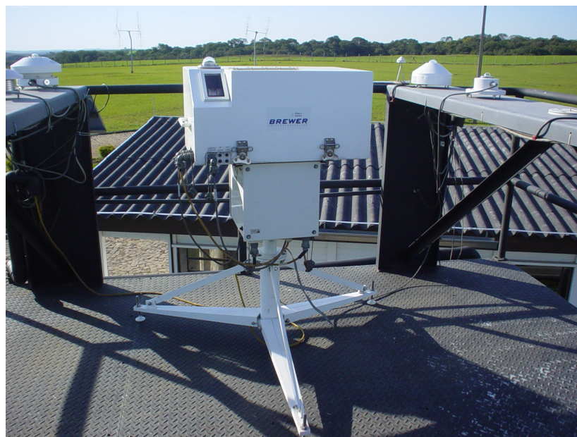
Fig. 14 – Espectrofotômetro Brewer MKIII #167 atualmente instalado no Observatório Espacial do Sul, CRSPE/INPE – MCT.
