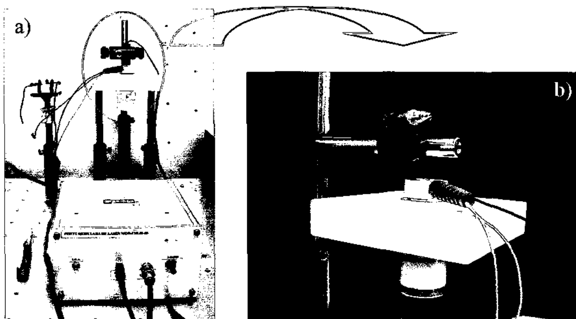
Figura 9. Arranjo experimental para realização de medidas fotoacústicas (a); e detalhe do novo sistema proposto (b).
