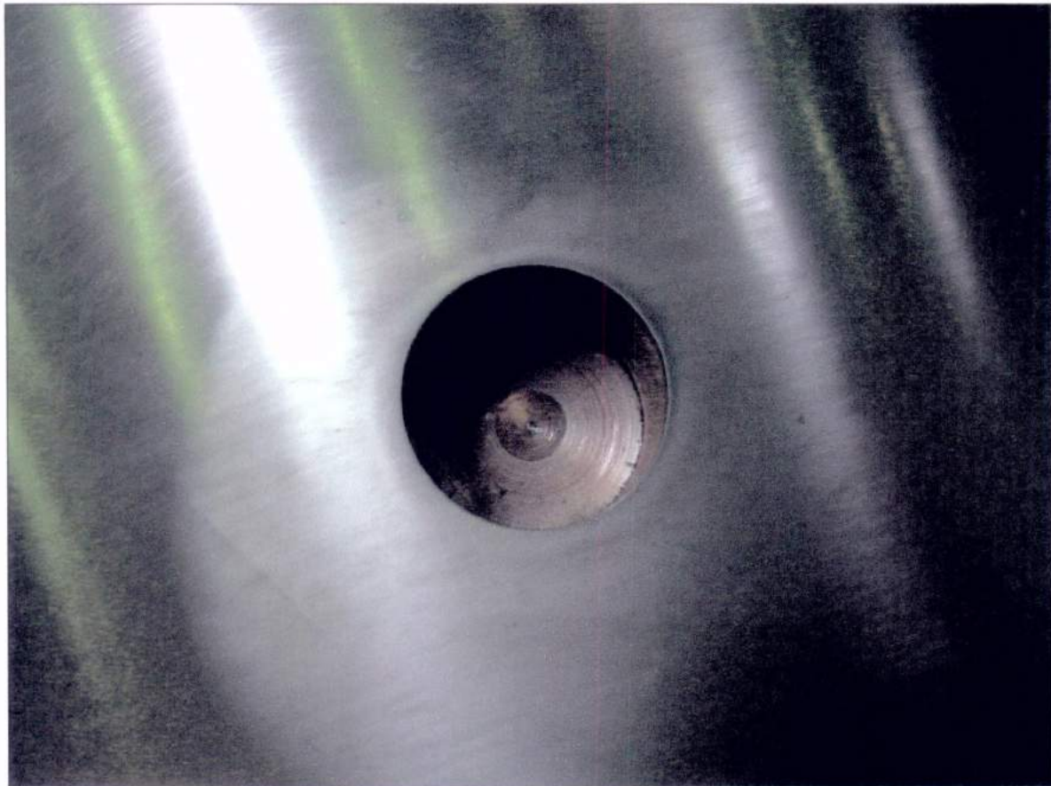
Fig.6-Detalhe da cavidade onde o transdutor será colocado
