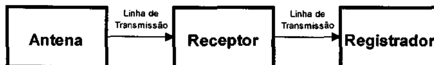
Figura 4.1.1 - Bloco esquemático de um sistema rádio-receptor para fins de estudos aplicados à Aeronomia.
