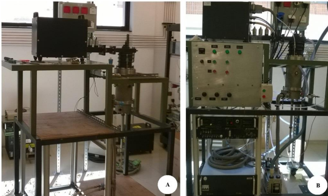
Figura 6: Sistema MWCVD de alta potência. A figura (a) exibe as condições iniciais do equipamento, em (b) o equipamento após a montagem.
