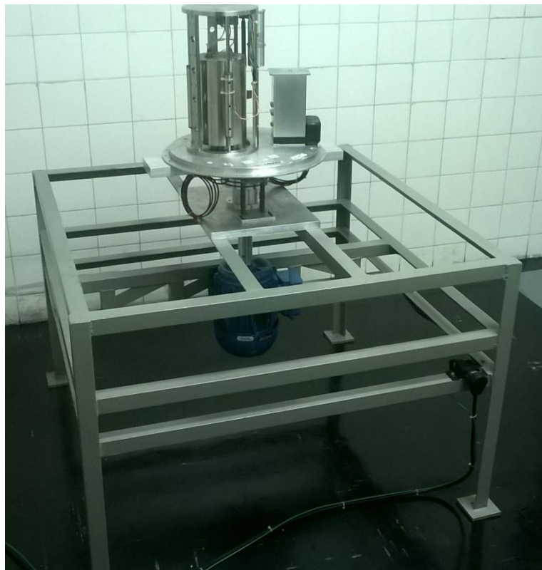
Figura 22– Centrífuga com o módulo de simulação de rotações.
