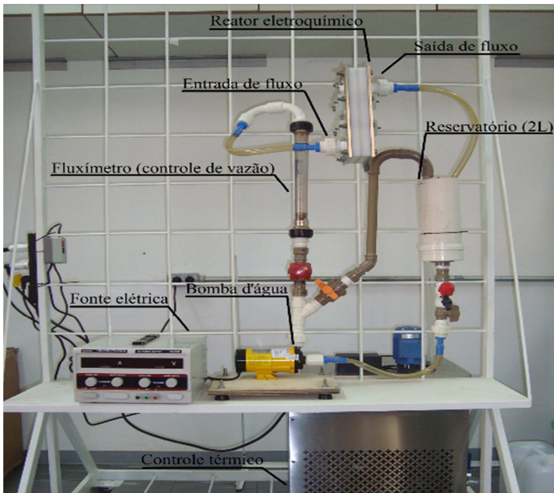
Figura – 1 - Reator eletroquímico de fluxo
