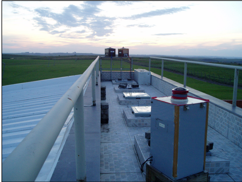
FIGURA 5-11: Câmera Imageador do tipo All-Sky (Sony DVCAM) na parte superior do Prédio 5 no Observatório Espacial do Sul do Centro Regional Sul de Pesquisas Espaciais – OES/CRSPE/INPE – MCT, em São Martinho da Serra, RS.
