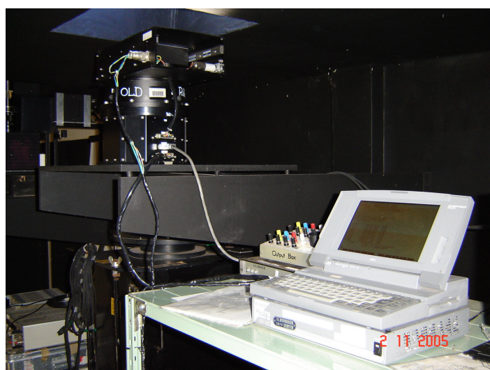
FIGURA 2-12: O Fotômetro 4 Janelas instalado no Laboratório de Óptica e Luminescência Atmosférica – LOLA.
