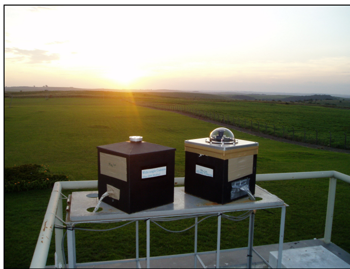
FIGURA 5-7: Câmeras Imageadoras Wide-Angle e Fish-Eye, instaladas junto ao Laboratório de Óptica e Luminescência Atmosférica – LOLA/OES/CRSPE/INPE – MCT, em São Martinho da Serra – RS.
