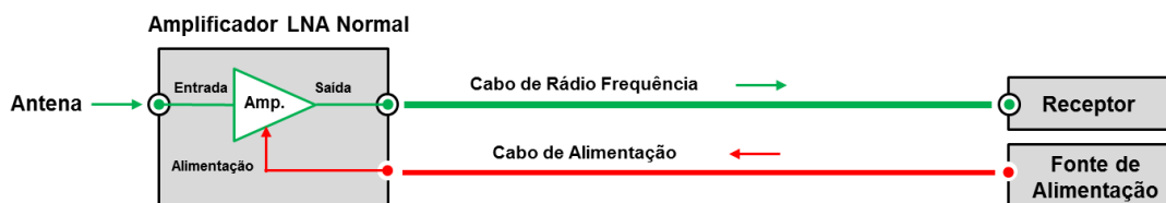
Figura 86. Amplificador LNA com Alimentação Separada
