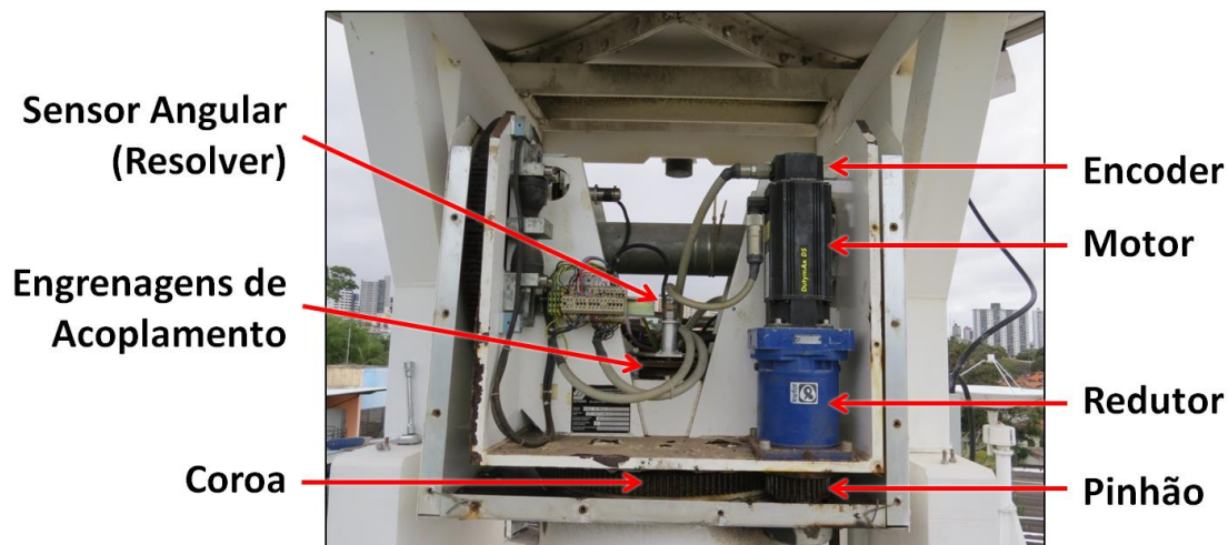
Figura 5. Componentes mecânicos do movimento de Azimute
