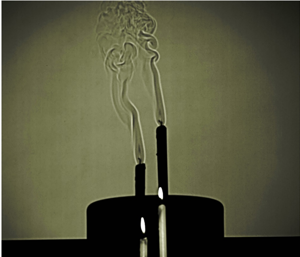
Figura 2: Imagem shadowgraph obtida em sala de aula das chamas e plumas convectivas de duas velas. Fonte: os autores.
