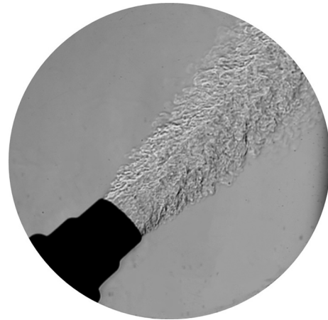
Figura 15: Imagem do escoamento turbulento de ar aquecido produzido por um secador de cabelo, obtida com um arranjo Schlieren-Toepler do tipo Z. Fonte: os autores.
