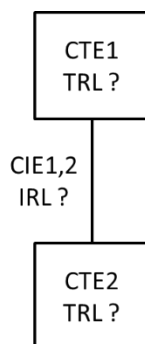
Figura 6.1 - Diagrama conceitual do subsistema ELT1: CTE1 – Elemento Crítico Tecnológico 1 (Bateria); CTE2 - Elemento Crítico Tecnológico 2 (Painel Solar); CIE1,2 – Elemento Crítico de Integração 1,2 (Integração Bateria / Painel Solar).
