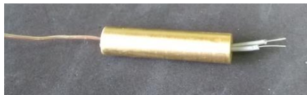
Figura 5.12 – Tarugo de latão para caracterização dos NTC's.
