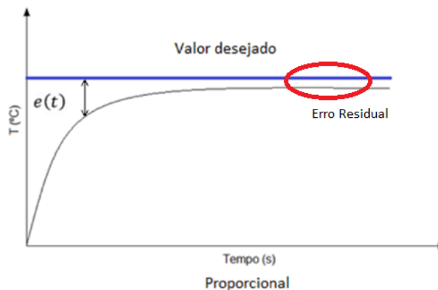
Figura 4.18 – Resposta do controle Proporcional.
