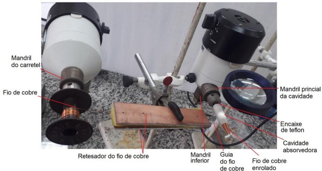
Figura 5.5 – Dispositivo para o enrolamento do cobre sobre a cavidade absorvedora.
