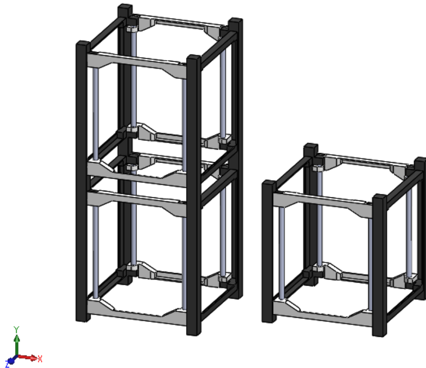
Figura 14 - Comparativo estruturas 1U e 2U.
