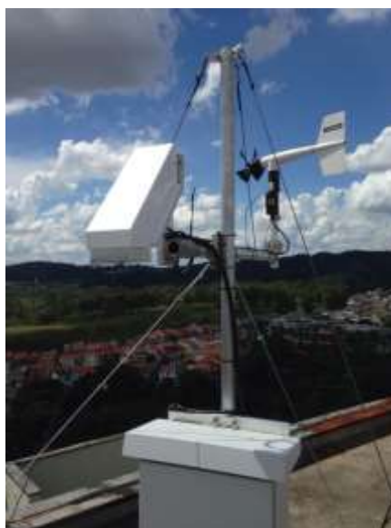
Figura 2.5 – Electric Field-Mill instalado nas imediações do INPE.
