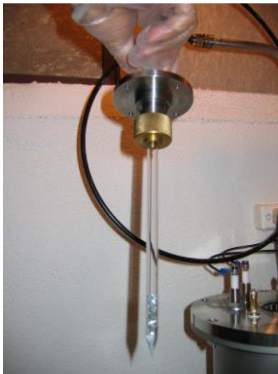
Figura 6. Dispositivo para pulverizar as amostras
