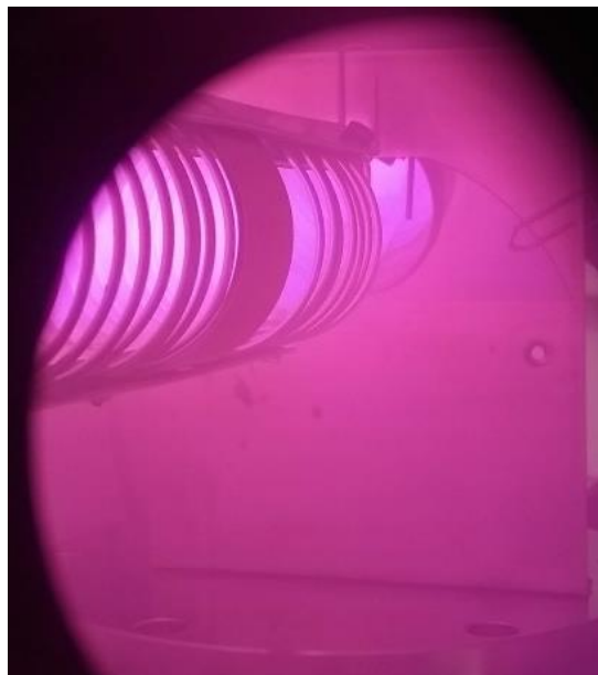
Figura 5.13 - Foto lateral do plasma do tubo espiral, com imagem refletida na lâmina de silício, para caso com corrente de 5 A, por 1 h.
