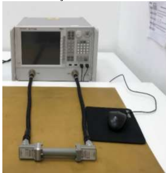
Figura 3.5 - Analisador de rede vetorial da Keysight acoplado ao guia de ondas retangular da banda K_u .
