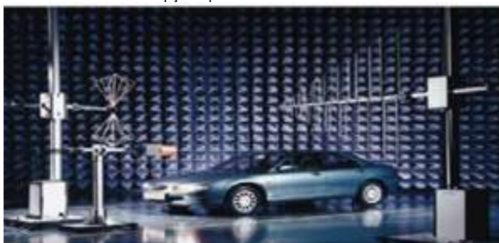
Figura 1.1 - Fotografia de uma câmara anecóica com um objeto entre antenas de emissão e recepção apontadas entre si.
