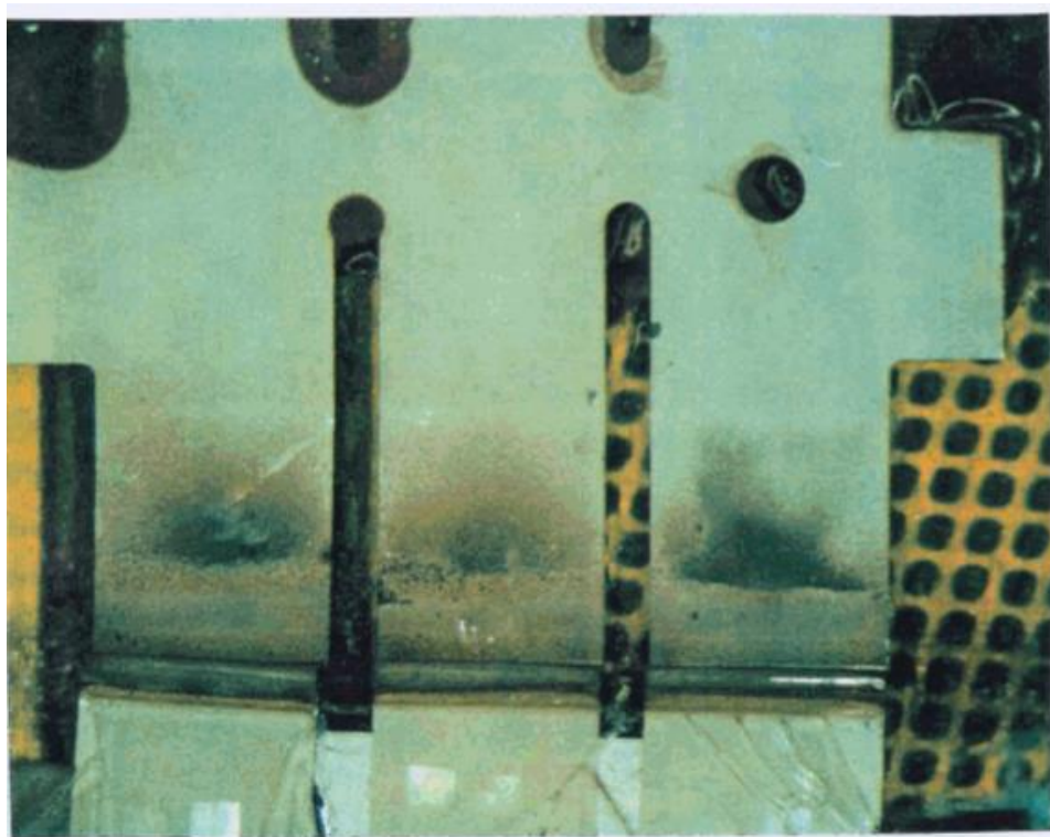
Figura 3.4 – Efeito do Oxigênio atômico em interconector.
