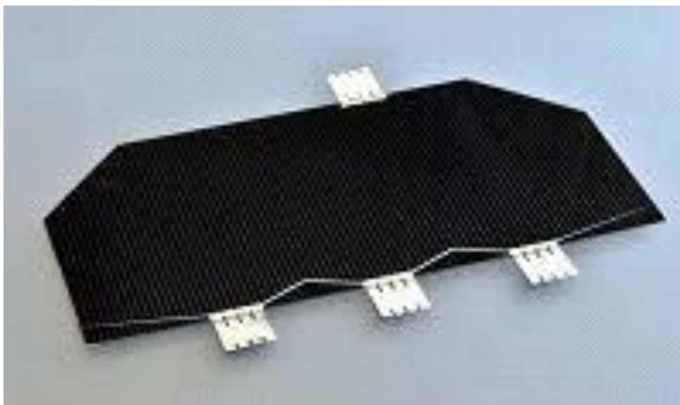
Figura 2.14 – Interconectores soldados ao barramento da célula solar.
