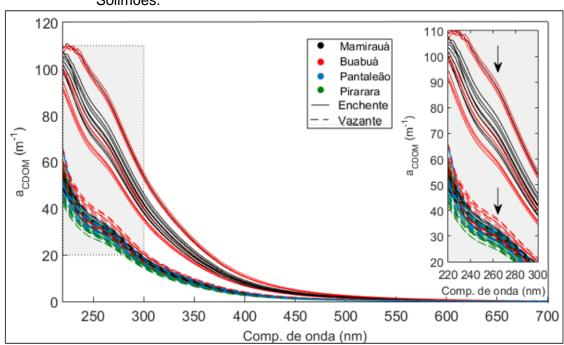
Figura 4.3 - Espectro de a<sub>CDOM</sub> coletado nos lagos da planicie de inundação do Solimões.
