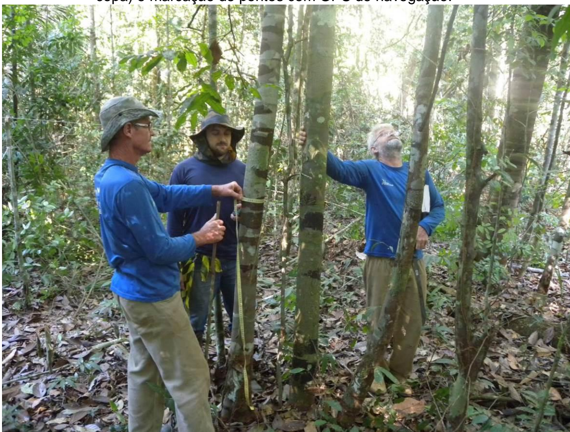
Figura 5.15 - Mensuração de atributos físicos das árvores (CAP, Htot, Hcom, raios de copa) e marcação de pontos com GPS de navegação.
