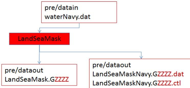
Figura12 -Processamento dos dados waterNavy para criar a máscara continente/oceano
