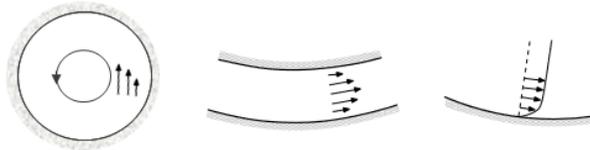
À esquerda escoamento confinado entre dois cilindros concêntricos, no centro escoamento num canal curvilíneo e à direita escoamento de camada limite sobre superfície curva.
