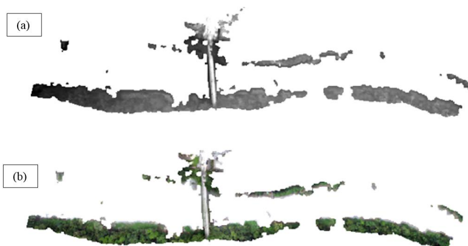
Figura 5.15 - Mosaico gerado do processamento das imagens de quatro bandas espectrais no software PhotoScan , em que (a) é o mosaico TIR e (b) a composição colorida RGB das bandas 1, 2 e 3.
