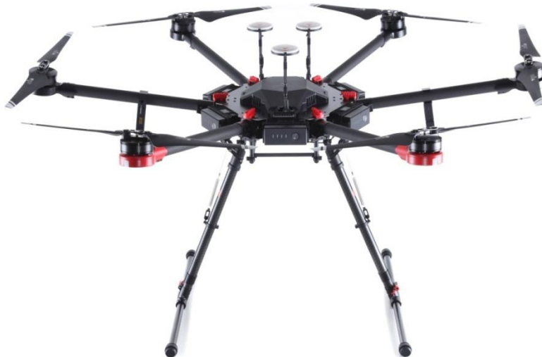
Figura 4.2 - Matrice 600 Pro, veículo aéreo não tripulado (VANT) utilizado para a aquisição das imagens termais aéreas.
