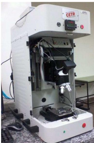
**FIGURA 3: Tribômetro utilizado nos ensaios de aderência.**
